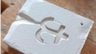
En primer lugar, necesitas un molde en el que puedas verter el estaño. Debe constar de dos partes que encajen entre sí. Hay moldes de metal, plástico o arcilla. Los moldes se limpian con polvo antes de la colada.
