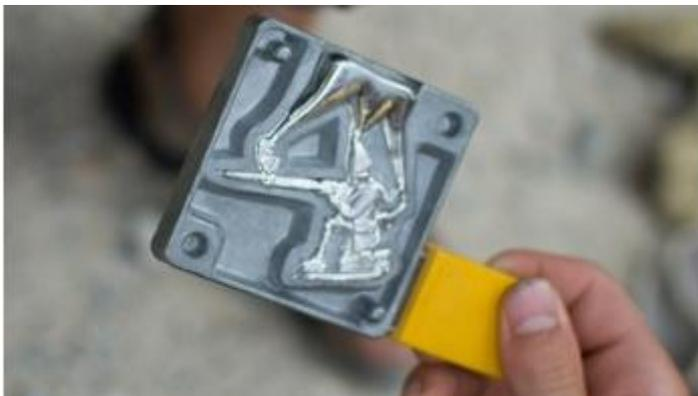
Deje enfriar el estaño en el molde hasta que esté frío en el punto de vertido (tóquelo con el dedo). (tóquelo con el dedo) En cuanto el estaño esté frío, puede aflojar la abrazadera de tornillo, apartar los trozos de madera y abrir el molde.
