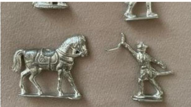
A continuación, presiona la figura para sacarla del molde y recorta el exceso de estaño. La figura aún puede acabarse con limas y papel de lija.
