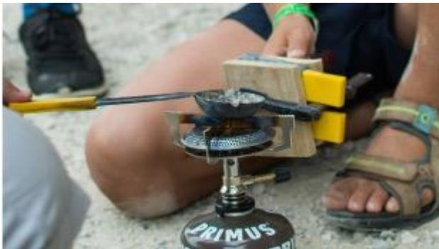
A continuación, los moldes se aprietan entre dos piezas de madera con una abrazadera de tornillo. Mientras tanto, se calienta el estaño en una cacerola pequeña de una cocina de camping hasta que se derrita. En cuanto el molde y el estaño estén listos, se puede verter el estaño líquido en el molde hasta llenarlo.
