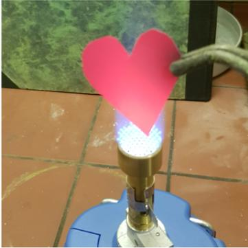
Das Kupferherz wird in der Flamme des Bunsenbrenners geglüht
