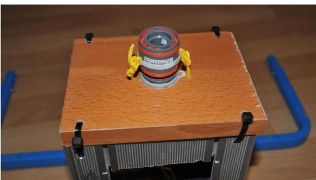
Nun wird die Schnur durch die beiden kleineren Löcher gefädelt und das Schlauchkupplungsmodul in die Bohrung eingeführt und festgedrückt. Es hat sich bewährt, dieses Modul nicht zu verkleben, so dass es für Reparatur-Zwecke immer wieder entfernt werden kann.
