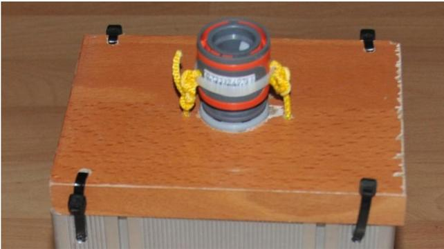
In das Gehäuse aus Holz, Metall, oder Kunststoff wird an der Oberseite ein Loch in der Grösse des unteren Teils der Gardena-Schlauchkupplung gebohrt. Der, im Bild hellgraue, Unterteil der Kupplung muss satt ins Loch passen, ohne dass die Beweglichkeit des Oberteils behindert ist. Links und rechts des Lochs werden noch zwei kleinere Löcher gebohrt, diese sind für die Durchführung der Schnur.
