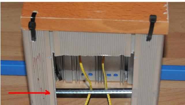
Auf der Seite des Gehäuses wird eine Öffnung angebracht, an der die Schnur raus geführt und der Velopumpen-Schlauch rein geführt werden kann. Zusätzlich wird im Gehäuse drin ein Stab eingesetzt, welcher zur Umlenkung der Schnur dient
