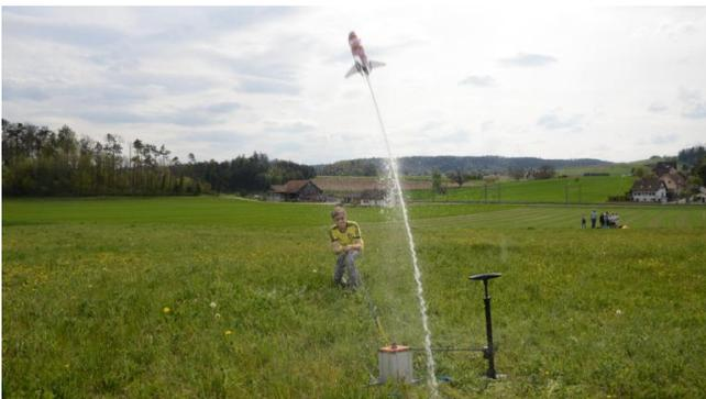
Für den Raketen-Abschuss wird nun die Startrampe auf einem geeigneten Gelände platziert und befestigt. Die Velopumpe wird am Autoventil angeschlossen und die Rakete mit einem Drittel des Flaschenvolumens mit Wasser gefüllt. Dann wird die Flasche mit einer schnellen Kipp-Bewegung auf die Startrampe gesetzt, möglichst ohne Wasserverlust.
