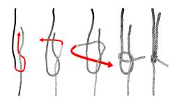
Der Schotstek ist ein geeigneter Knoten, um ungleich dicke zu verbinden. Er ist verwandt mit dem Samariter und dem Palstek.
